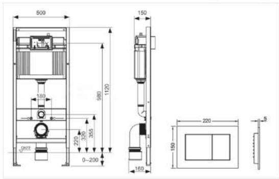
Схема инсталляции в 2х сан узлах
